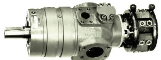
Radialkolbenpumpe an einer Deripumpe der Firma Sauer & Sohn (1958)
